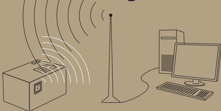
1. Le signal RF active l'étiquette quand il entre dans le champ RF créé par l'antenne
